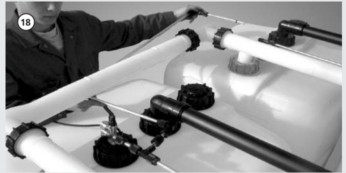
18 An die einzelnen Entnahmeleitungen anschrauben. Screw on to individual suction assembly line. La visser aux conduites de remplissage individuelles. Aan de verschillende aftapleidingen schroeven.
